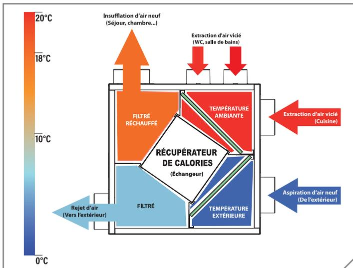
**Schéma des flux d'air traversant l'échangeur thermique sur nuancier couleur indiquant les degrés de 0° à 20° C.**
