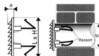
La fixation par ressort autorise la pose et dépose instantanées et s'adapte automatiquement à la forme et au Ø du trou.
