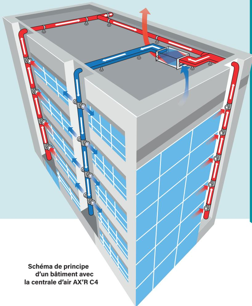
Schéma de principe d'un bâtiment avec la centrale d'air AX'R C4
