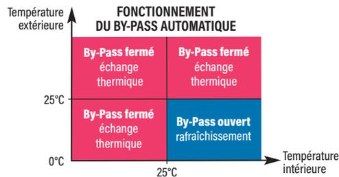
La VMC DF72 HYGRO BP Auto est équipée d'un by-pass partiel à commande automatique qui permet de diminuer l'échange thermique en été lorsque ce dernier n'est pas nécessaire.
