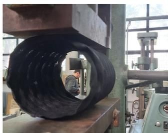
Les spires rapprochées en acier avec un diamètre renforcé de 0,965 mm permettent au conduit intérieur de supporter une charge sans déformation des performances aérauliques.
